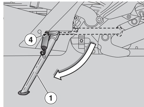
Sur la béquille latérale (1) se trouve un contacteur de sécurité (4) ayant la fonction d'empêcher ou d'arrêter le fonctionnement du moteur avec rapport engagé et béquille latérale (1) dépliée.
