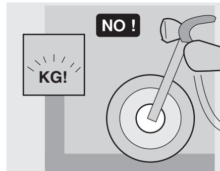
Ne pas dépasser la limite maximale de poids transportable pour chaque porte-bagages.
