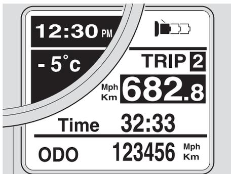
Au cas où les poignées chauffantes (si prévues) seraient présentes et actives, l'afficheur visualise à la place de l'indication du TRIP sélectionné une icône dédiée alors que l'indication du TRIP est reportée dans la zone sous-jacente. L'icône identifie l'intensité de chauffage en trois niveaux.
