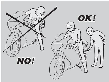
D'ailleurs le passager doit monter et descendre du véhicule en bougeant avec attention afin de ne pas déséquilibrer le véhicule et le pilote.
