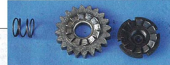
Mitunter verschlissen: Die Stirnverzahnung des Kickstarterfreilaufs
