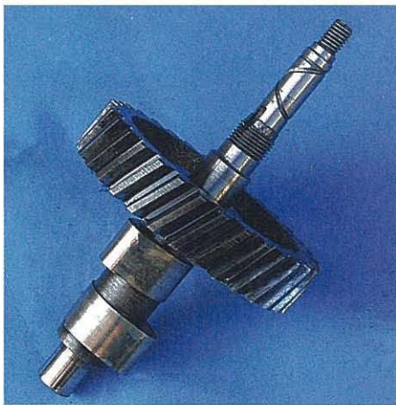
Weniger hart betroffen als die Stößelbecher: die Nockenwelle des ohv-Einzylinders
