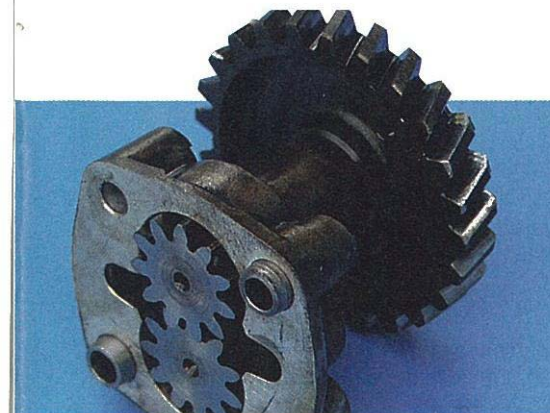
Die Ölpumpe ist leistungsstark genug, der Ölkreislauf aber ein Optimierungskandidat
