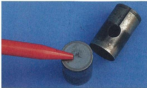
Unnötig schwere Ventile, knallharte Ventilfedern, wenig Öl – Pitting ist die Folge
