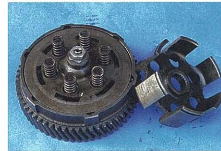
Normaler Verschleiß: Innerer und äußerer Kupplungskorb neigen zur Riefenbildung
