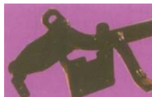
Schweißteil am Rahmenunterzug
