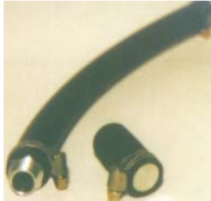
Entlüfterschlauch Stirndeckel und Verschlussstück ex. Motorentlüftung
